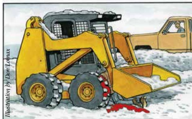
máquina o entre los brazos de elevación y el cuerpo. Justo antes del accidente, la mayoría de personas estaban paradas o trabajando debajo de una pala elevada, o estaban inclinadas hacia fuera de la cabina en el camino de los brazos de elevación.
